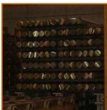
Figura 2: castello (o carica) con 7 strati, ciascuno costituito da 14 billette appoggiate su 8 traverse metalliche (ognuna del peso di circa 2 quintali) che mantengono distanziate le billette
